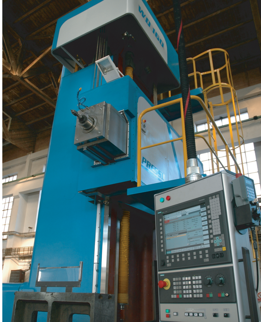
Horizontální desková vyvrtávačka Škoda WD 160 nazývaná „bruselka“ – modernizována firmou Pressl a osazena vřeteníkem z produkce Fermat
