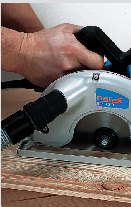
Připojení kotoučové pily k vysavači pro dokonale čistou práci
