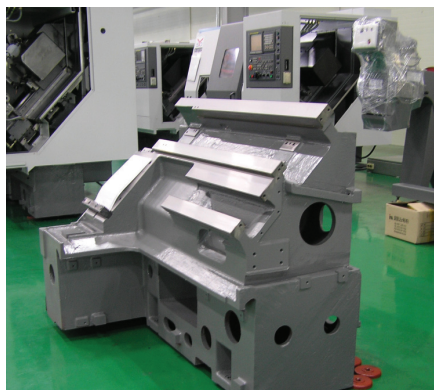
Lože soustruhu připravené pro montáž.
