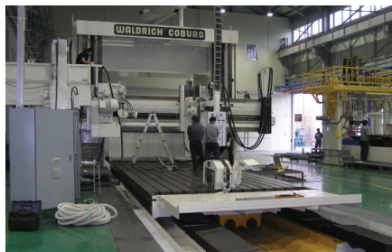
Portálové centrum Waldrich Coburg ve výrobní části závodu.
